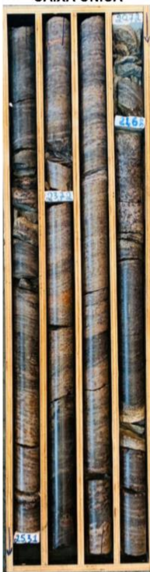
Figura 4 - Caixa de testemunhos de sondagem rotativa realizada em Varginha / MG. Extraído de Relatório de Sondagem - Varginha / MG
